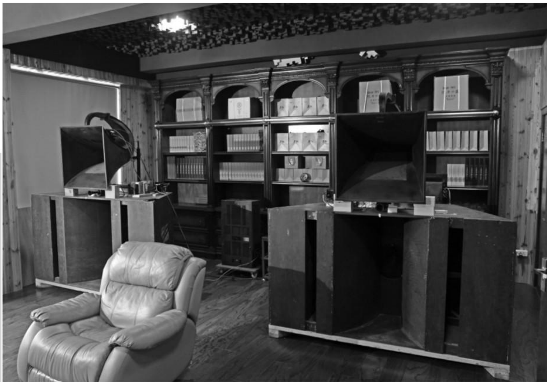
立體聲體系由《西電》555、597 及 4151 三款最早期勵磁單元組成，配合 WE22 號角及 Simplex 低音號角箱，效果如虎添翼。
