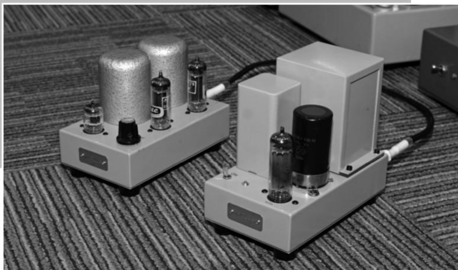
此迷你前級由 1 支《西電》396A 及 2 支 GEC 2293 組成放大部份，還附有輸出牛，聲音生猛活躍。
