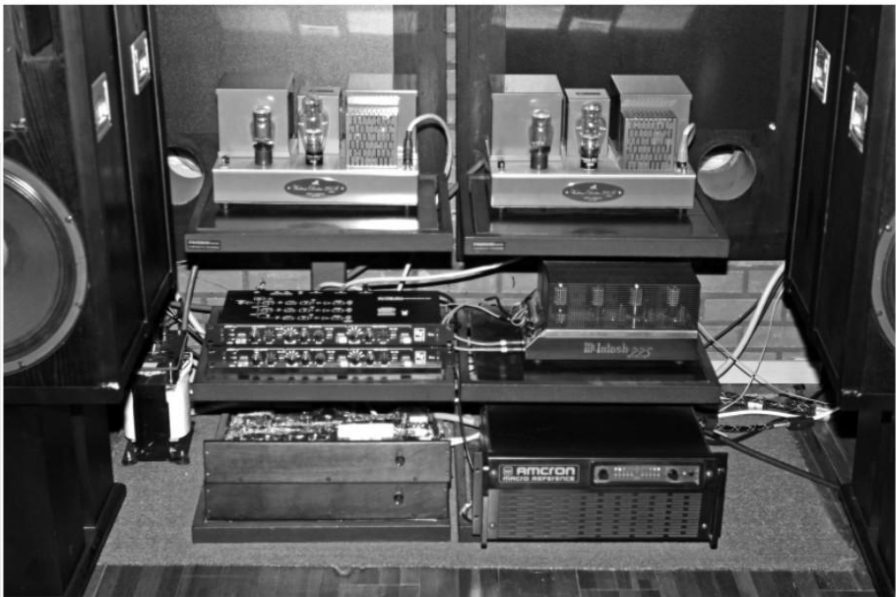
現場的擴音機組合，而最上層的一對 Mono Block 就是用來推動復刻 15A+ALTEC 288 的日本 SHINDO LAB WE300B。
