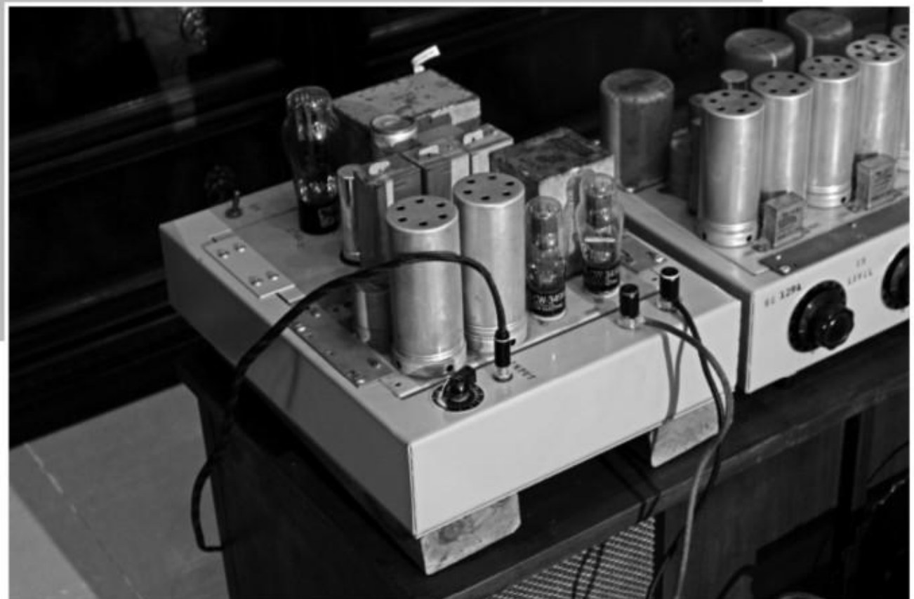
使用 WE349 膽作推挽工作的《西電》131 後級，是推動超高效率喇叭的能手。
