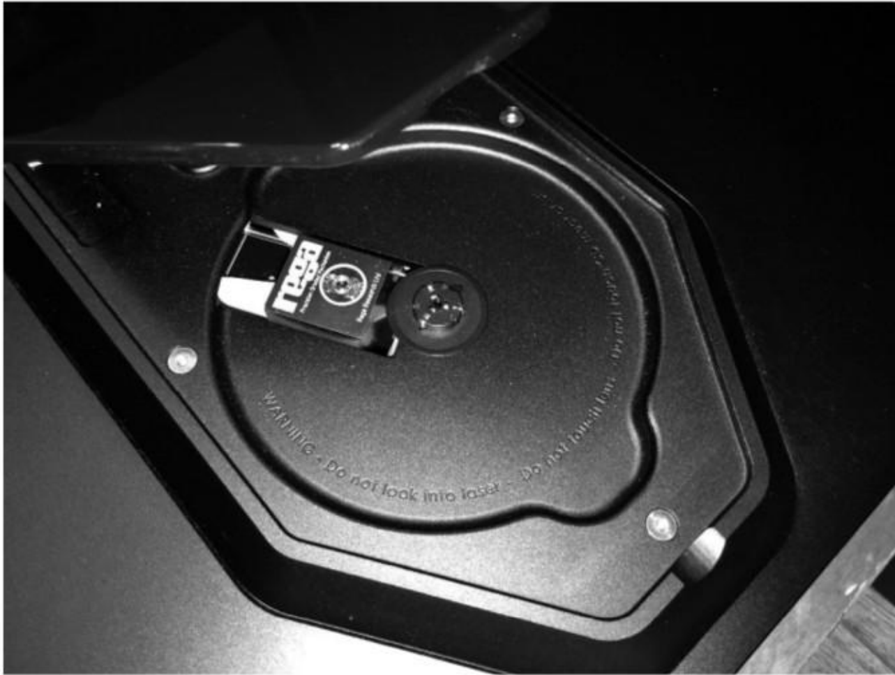
Isis 以整件鑄鋁打造的機芯部份，而鐳射頭更註明 Precision Graded Mechanism。
