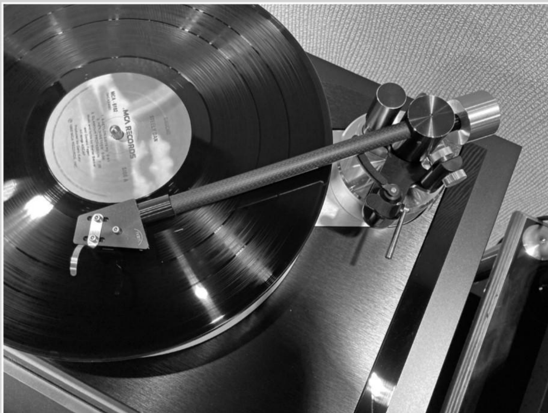
此新版 Aro 各部件都已經過大幅改良，例如特粗的碳纖臂管，與及可以一邊聽聲一邊調校 VTA 的旋扭，還有尾陀改為偏軸式低重心設計。
