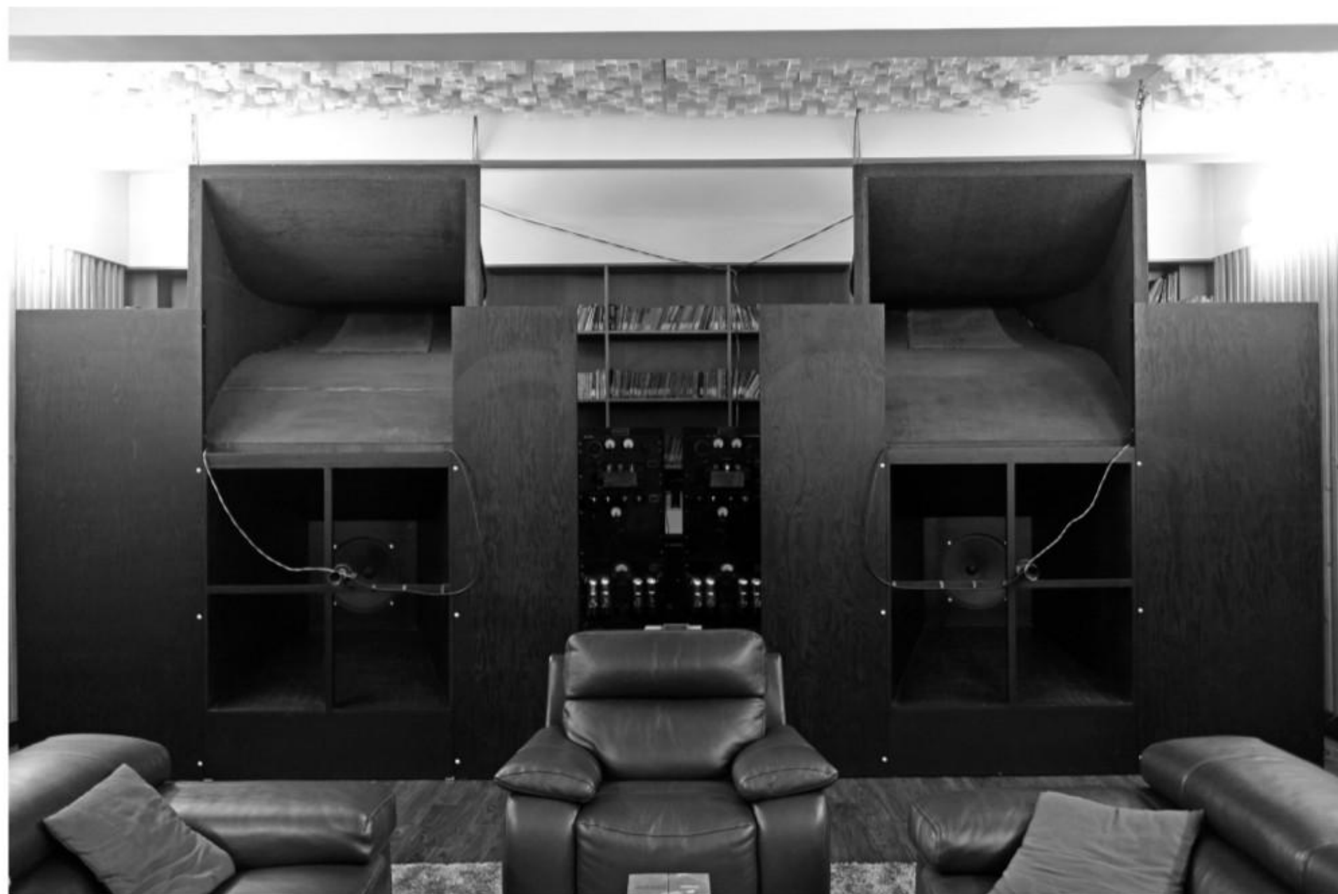
由 597 高音、555 驅動器 + 15 號角與 4194 低音 + TA7395 障板組成的《西電》勵磁喇叭體系，能將古典錄音重播得如幻似真。
