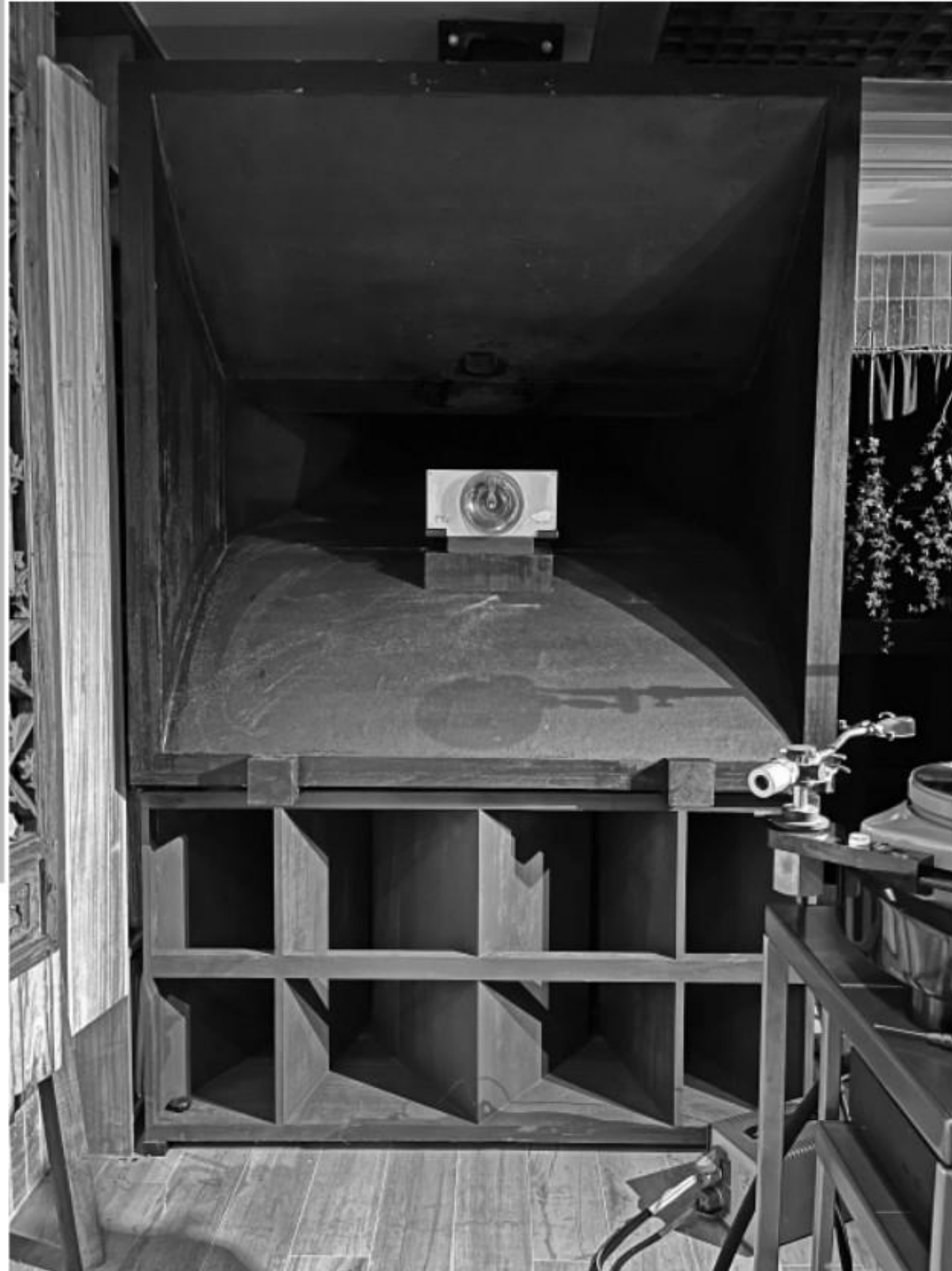
此復刻 WE15A 單元方面就選配了同屬復刻的 WE555 勵磁中音，再配搭 ACAPELLA 火燄高音和 GOODMANS 低音。
