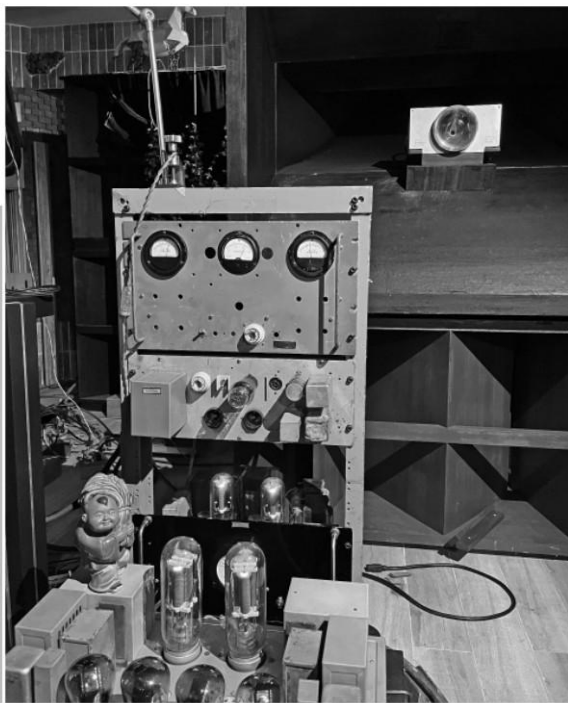
擴音組合的前級以《西電》8A 架構為藍本，放大線路為 102 D 推 101 D，後級則是 211 單端配 211 整流，全部都是《新時》辛師傅的手筆。
