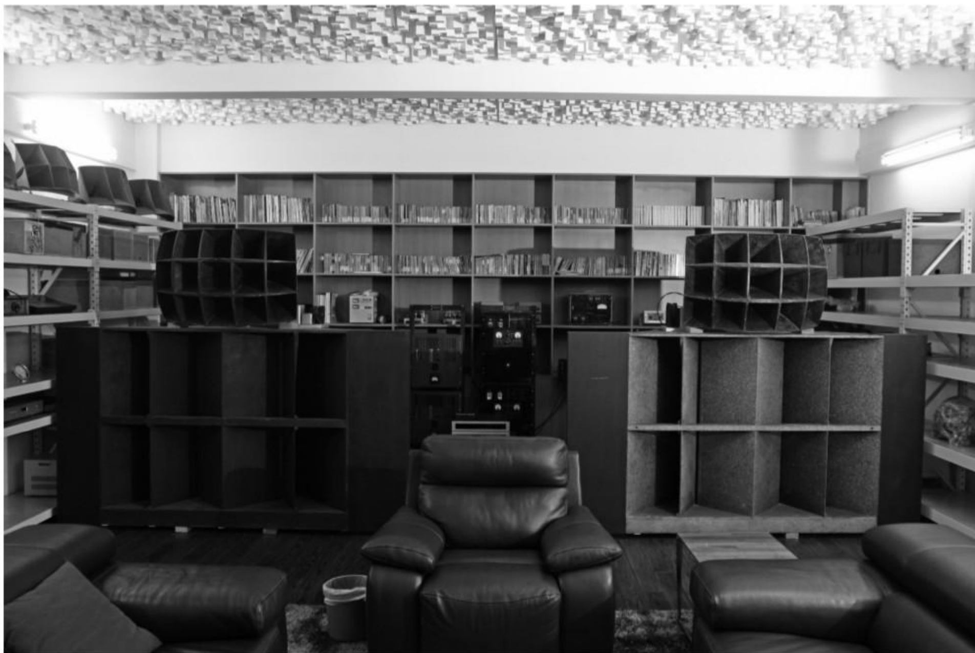
由 594 驅動器 +26 號角與 4181 低音 +TA7396 障板組成的古董《西電》勵磁喇叭體系，實力之強足以駕馭任何錄音。
