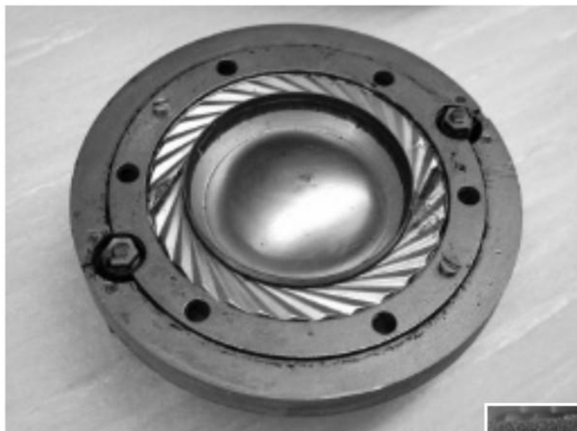
WE555 最好的版本叫「斜線版」，其音圈引線是順著太陽花震動環的斜邊而引出。
