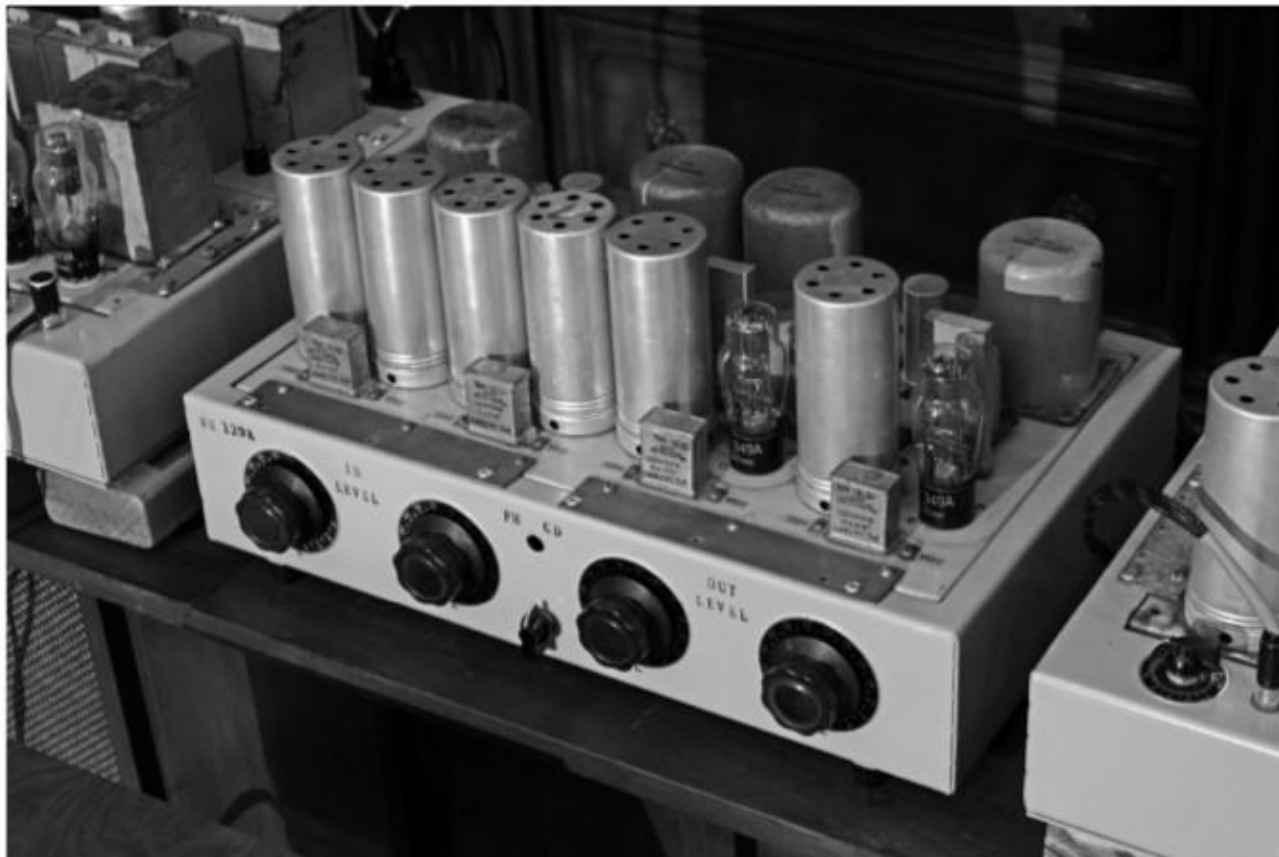
《西電》129 前級是萬能老倌，可以同時擔任唱頭及 Line Amp 放大工作。
