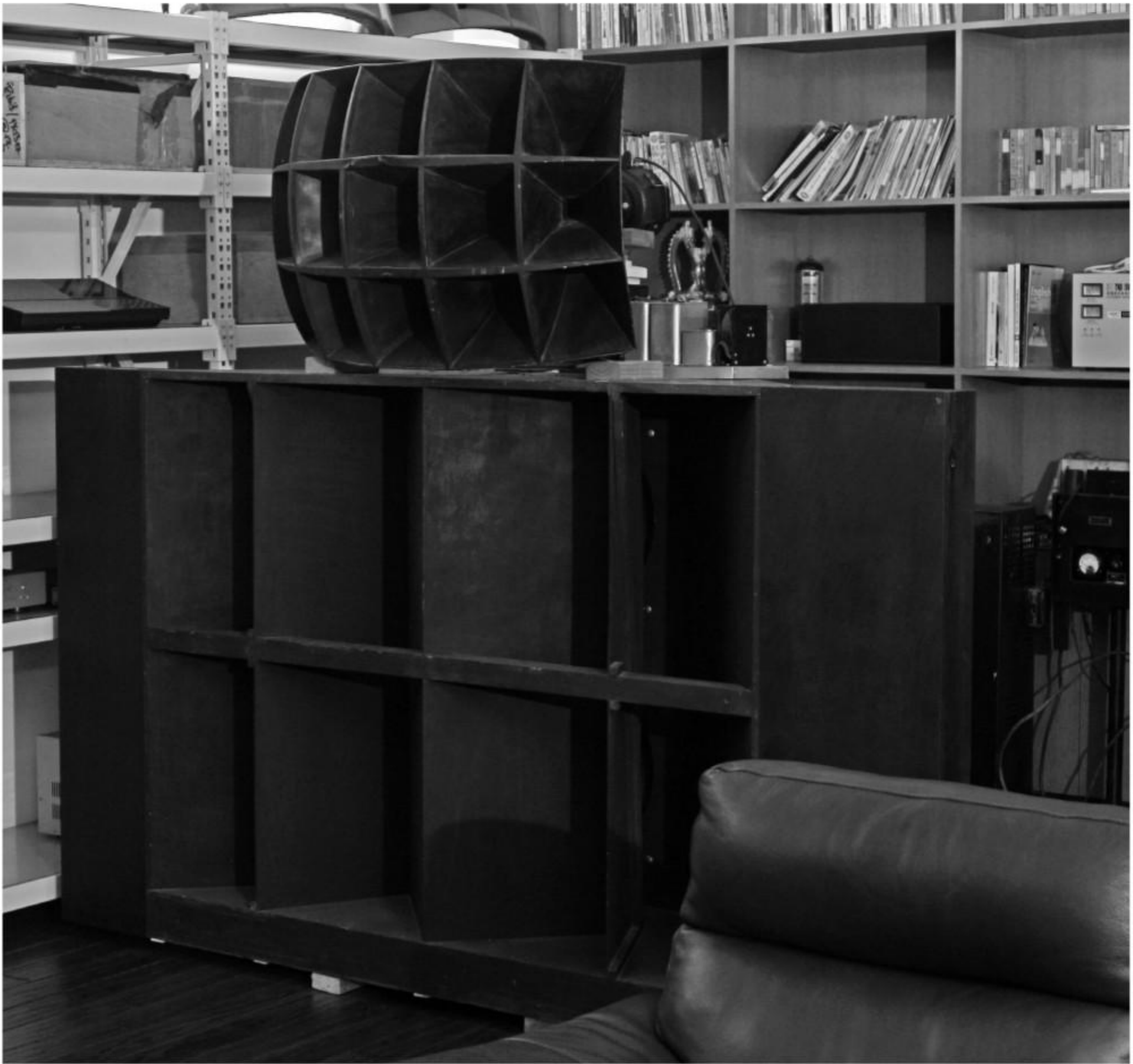
由 594 驅動器 +26 號角與 TA4181+TA7396 組成的喇叭體系，是史上實力最強的二路喇叭。
