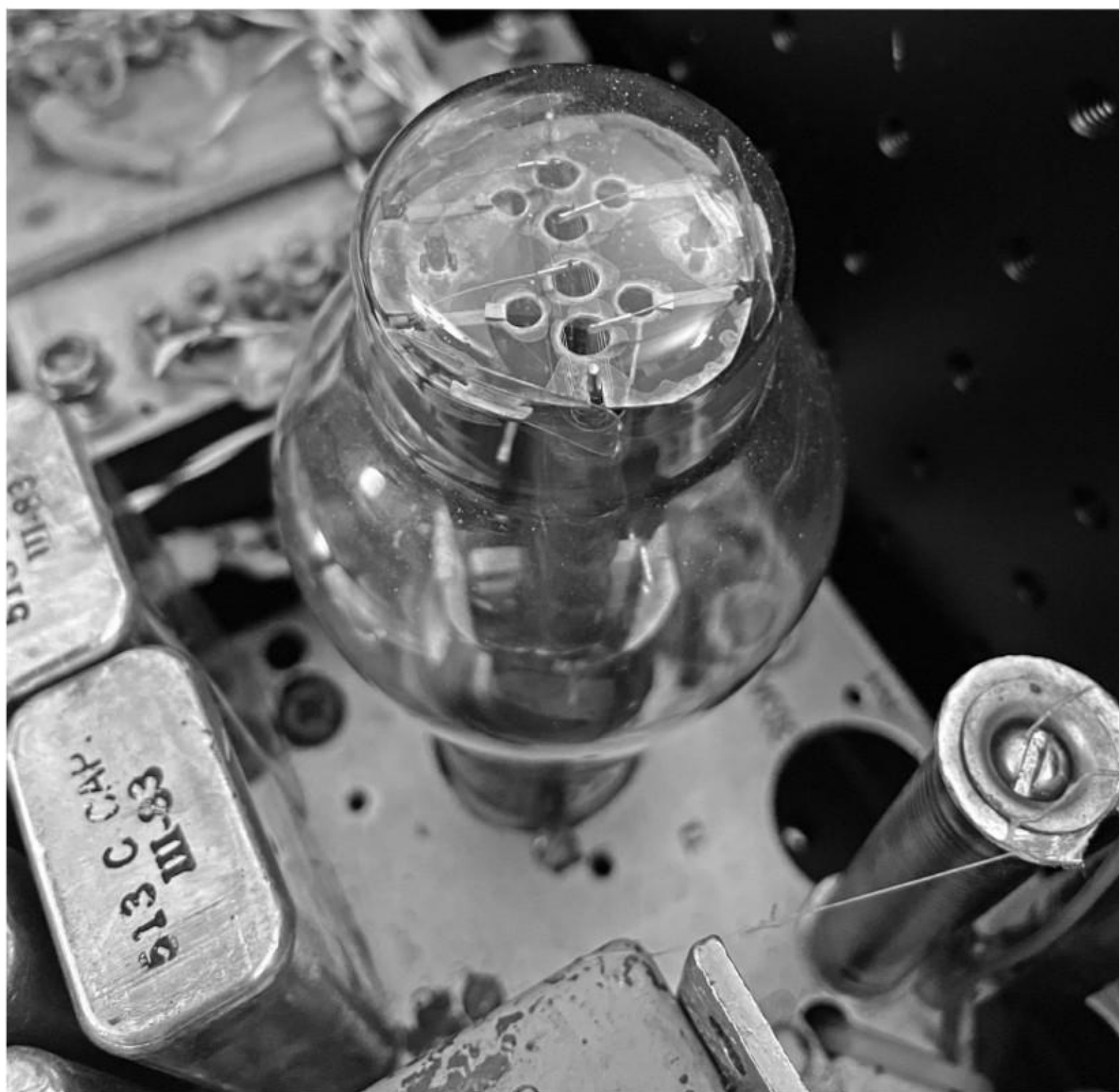
前級和後級的整流管皆可用西電 274A 或西電 300B，圖中的前級整流管已換上西電 300A。
