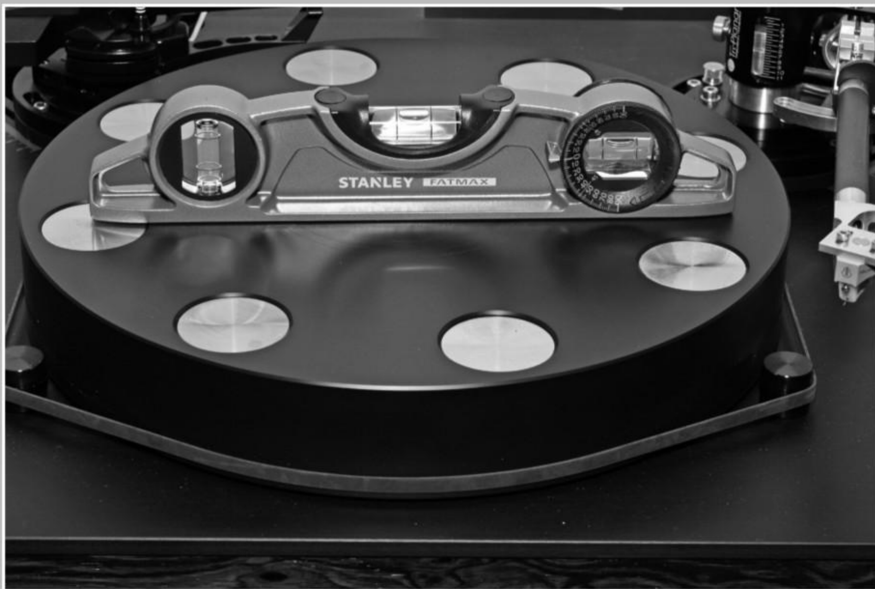
調校盤、臂、頭其中第一步，可以由調校唱盤水平開始。
