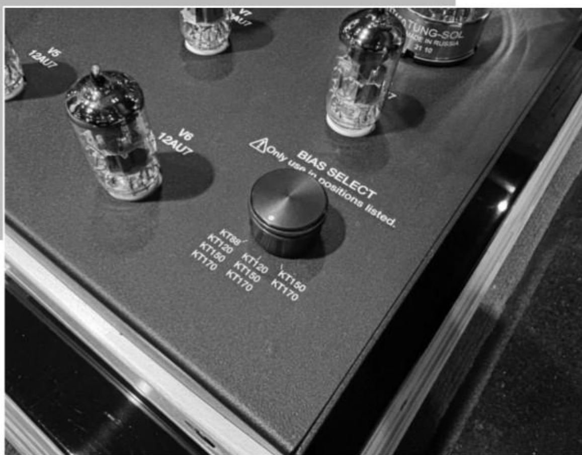
Bia Select 200 也可以兼容 KT-88、KT120 和 KT170，而且可以透過機上的三檔 Bias 打掣去選擇，並同時調節輸出瓦數。
