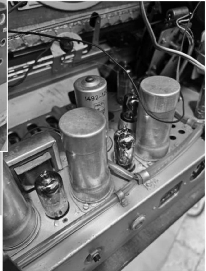
超過七十年歷史，但啲 PHILIPS 鐵殼電容連一點銹蝕都沒有，而且平滑光亮，尤如新品一樣！
