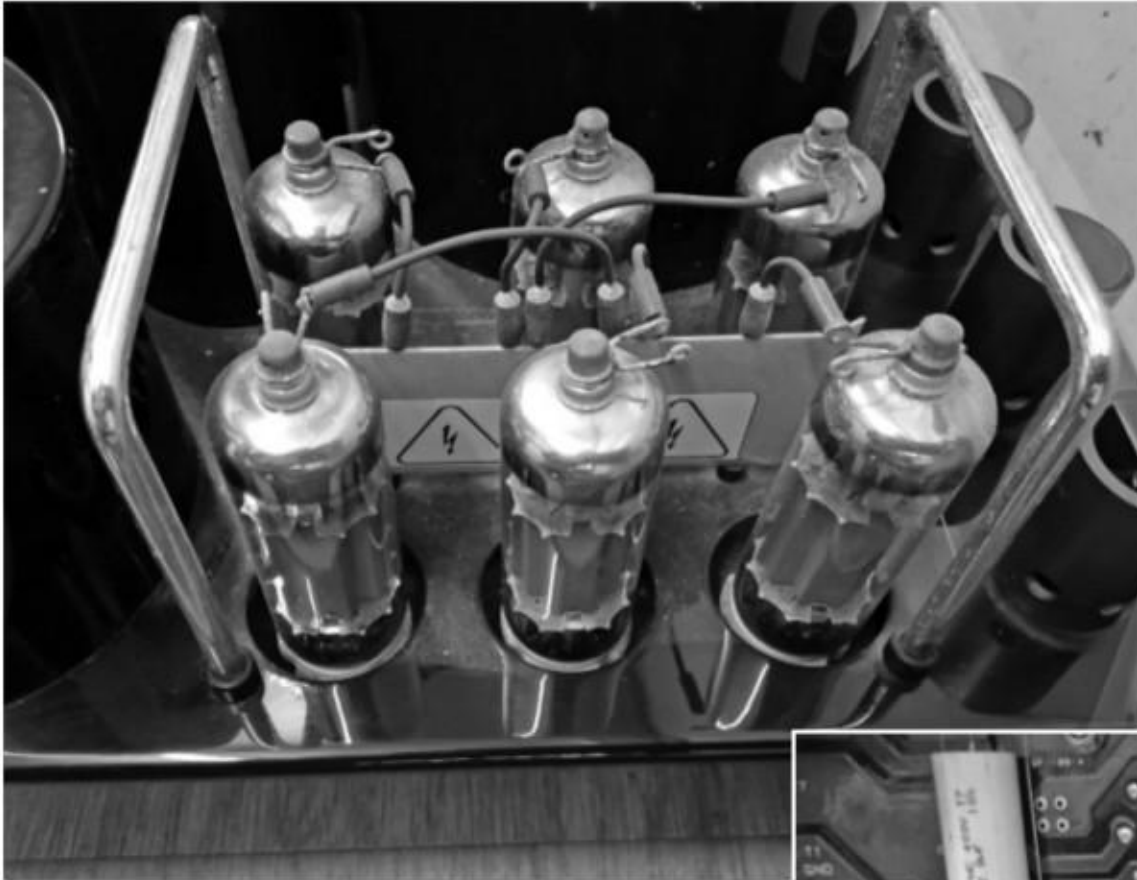
GM-100 其中一聲道的 PL-504 強放管，雖然部機啲聲真係幾好，又夠力，只係要接受 D 膽比較冷門，唔係咁容易買得到。
