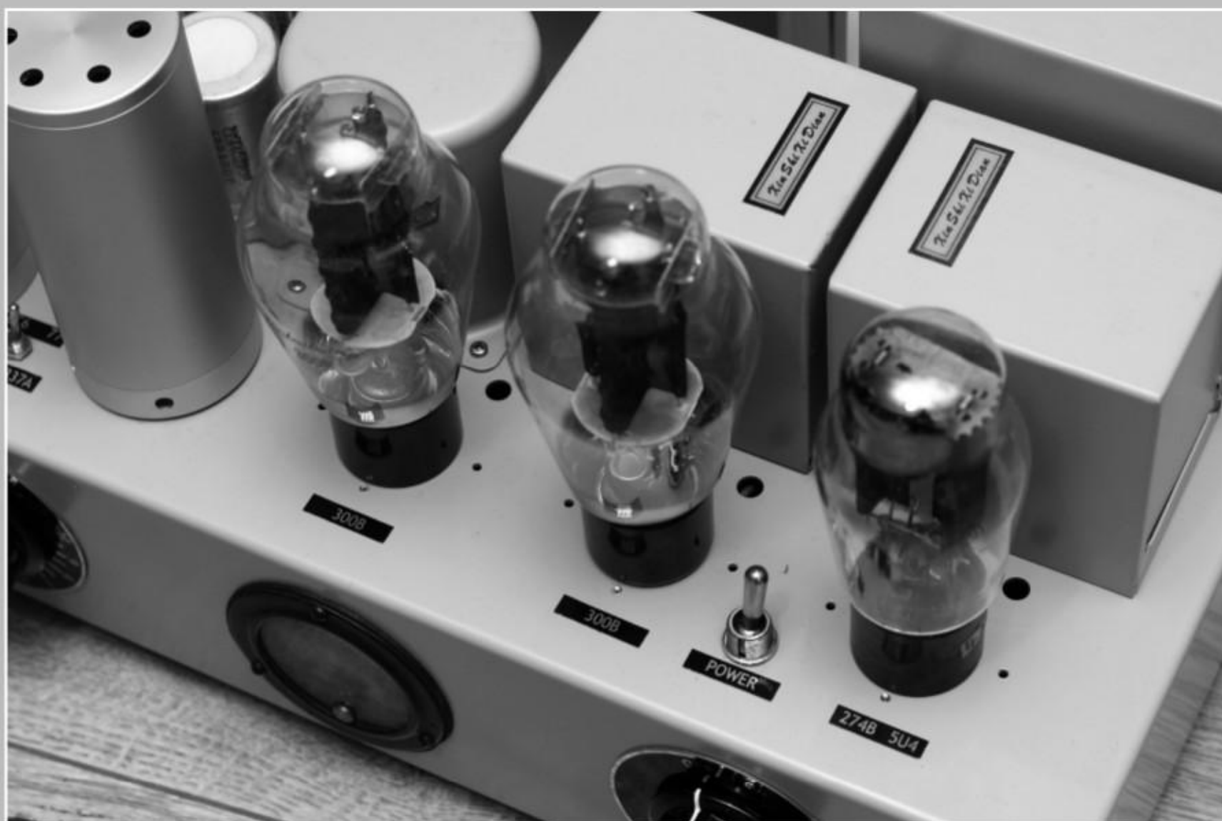
《新時》86 附加了一個獨立高壓電開關，待開機後幾分鐘才啟動，可以大幅提升 300B 的壽命。
