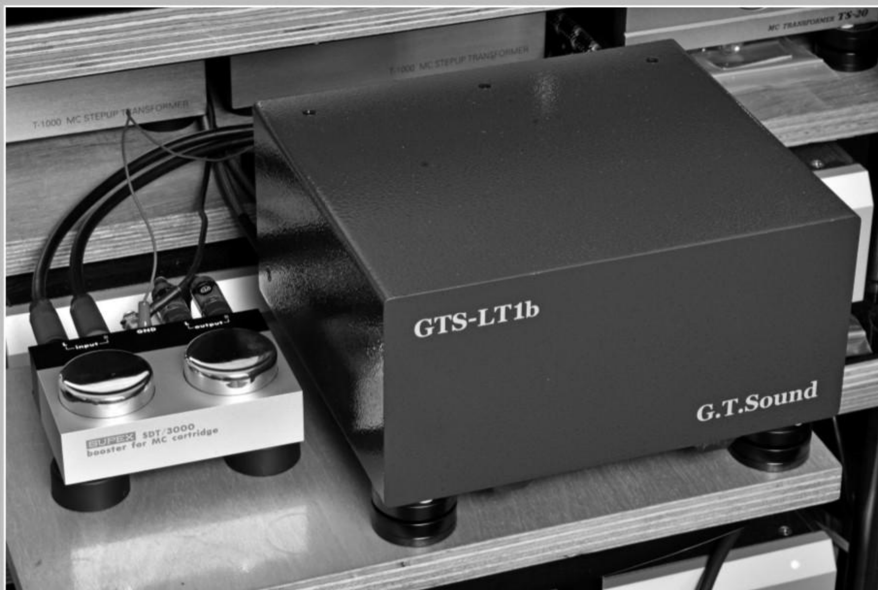
本文要借兩個分別是蠅量級的 SUPEX SDT-3000(左)，和超重量級的 G.T.SOUND GTS-LT1b(右)優質 MC 昇壓「牛」，去探討一下以重量為根據作出判斷是否合理。
