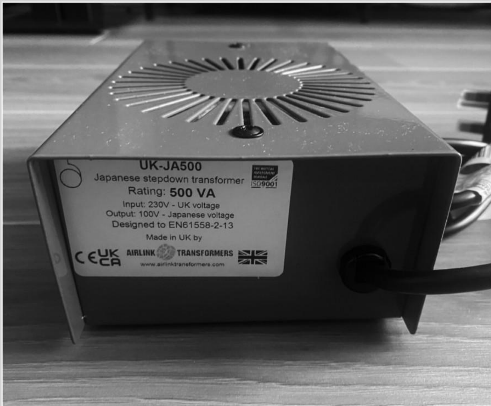
特別訂購供日本 100V 電壓使用的變壓器，外觀是簡約工業風，一個灰色鐵殼強度足夠，從鐵殼散熱孔見到使用的是一隻環牛。
