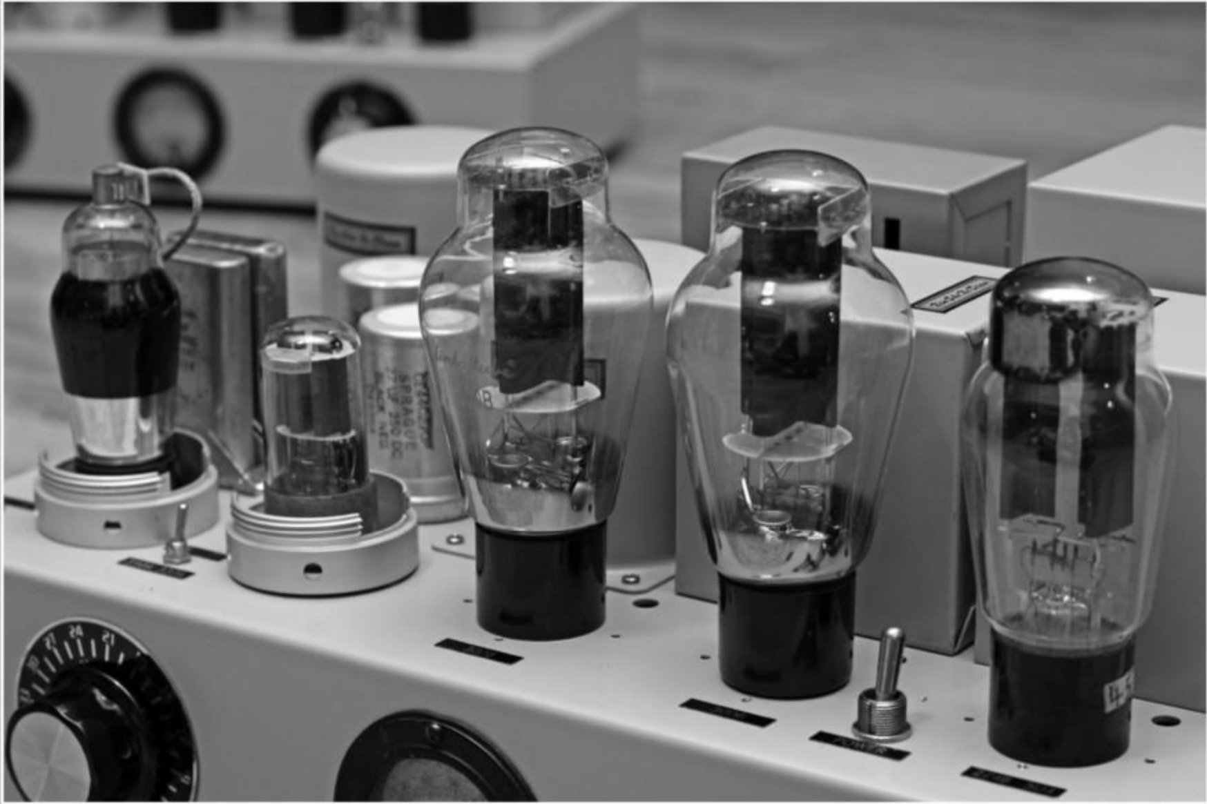
《新時》86 的放大部分由 1 支 310A、1 支 6SN7 及 2 支 300B 組成，整流部份則由一支 5Z3 負責。
