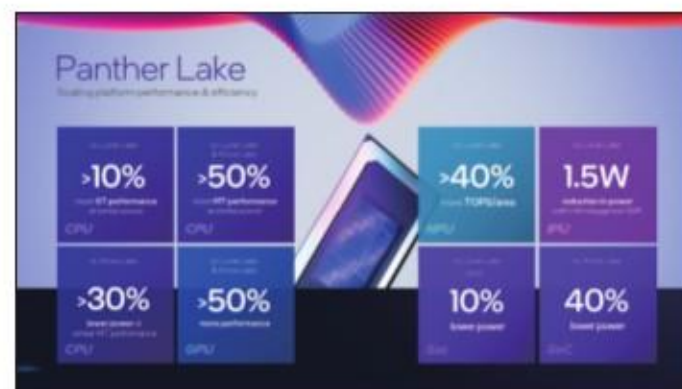
代號為Panther Lake的Core Ultra系列3處理器，整合最高12組Xe3核心內建顯示晶片，以及AI運算效能達50 TOPS的神經處理器。
