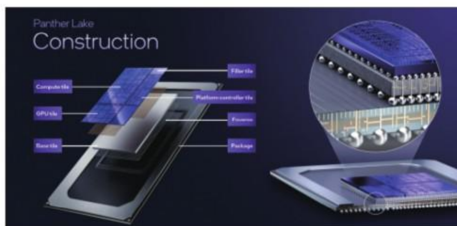
Panther Lake由運算模塊 (Compute Tile)、繪圖處理器模塊 (GPU Tile)、平台控制模塊 (Platform Control Tile) 構成，並透過Foveros 2.5D技術封裝為SoC (System on Chip, 系統單晶片)。
