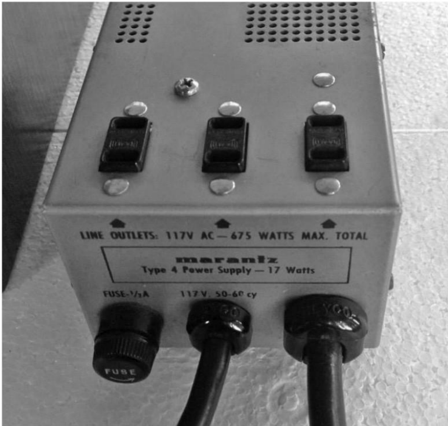
單聲道電源供應採用石整流。
