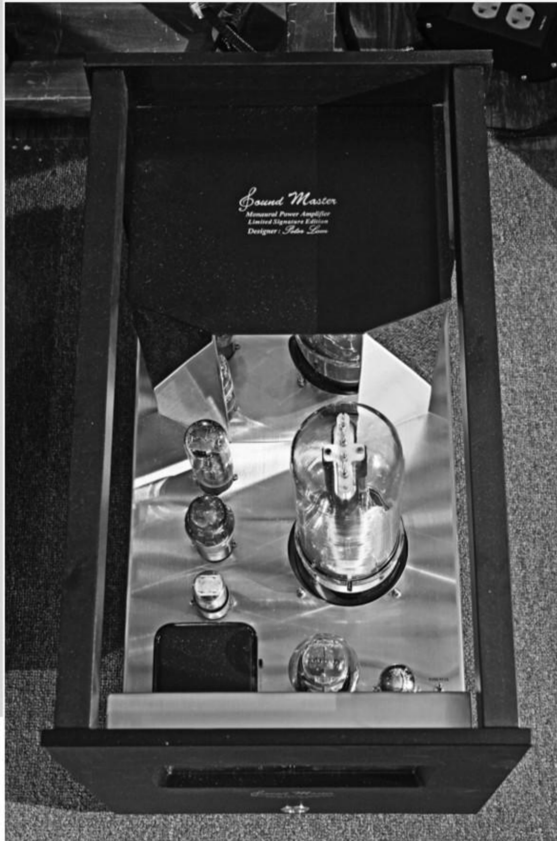
No.212WE 採用與 212 同宗的夢幻之球 300B 去推動 212，而輸入級亦用上《西電》的蘑菇膽 717A，實行盡量 WE 化。
