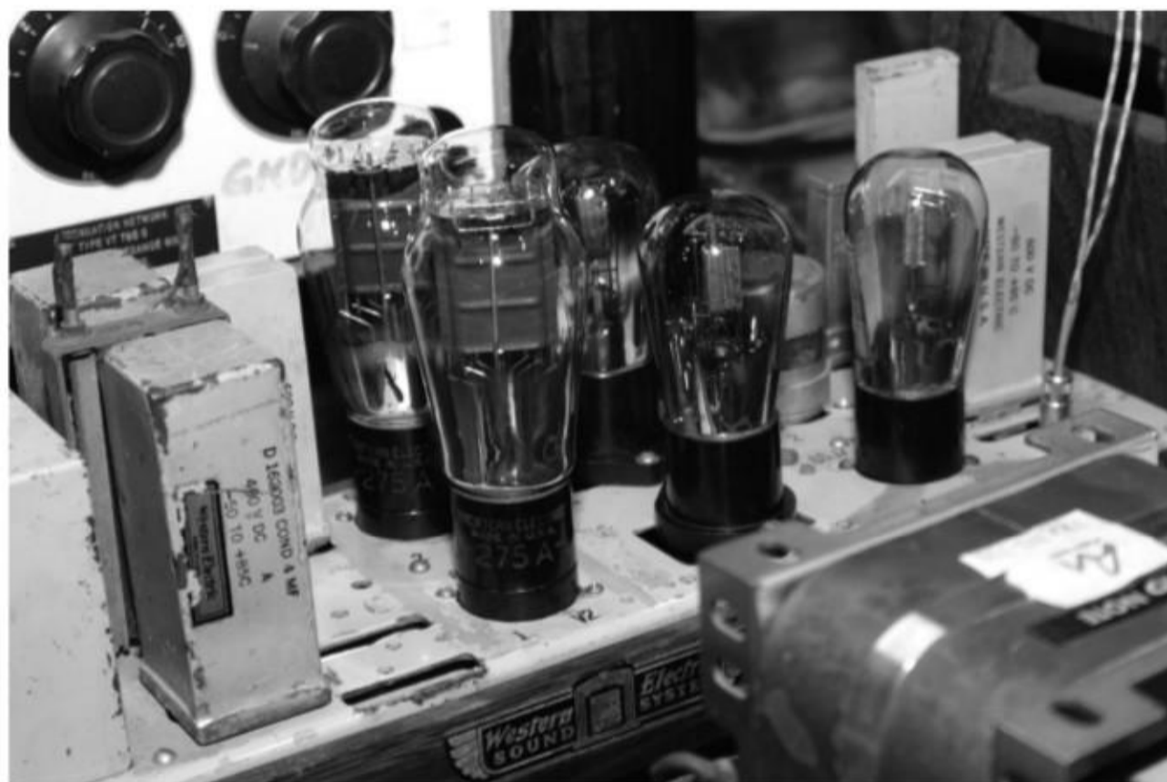
膽後級中的推動工作由遠古的《西電》244A 波膽負責，讓功率膽 275 發出了與別不同的好聲音。
