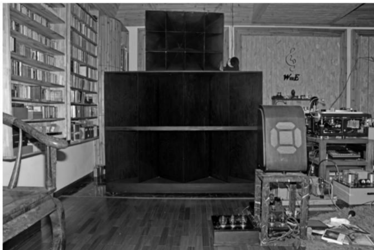
勵磁喇叭體系由《西電》594 驅動器、24 號角、HF18 低音及復刻版 7396 障板組成。
