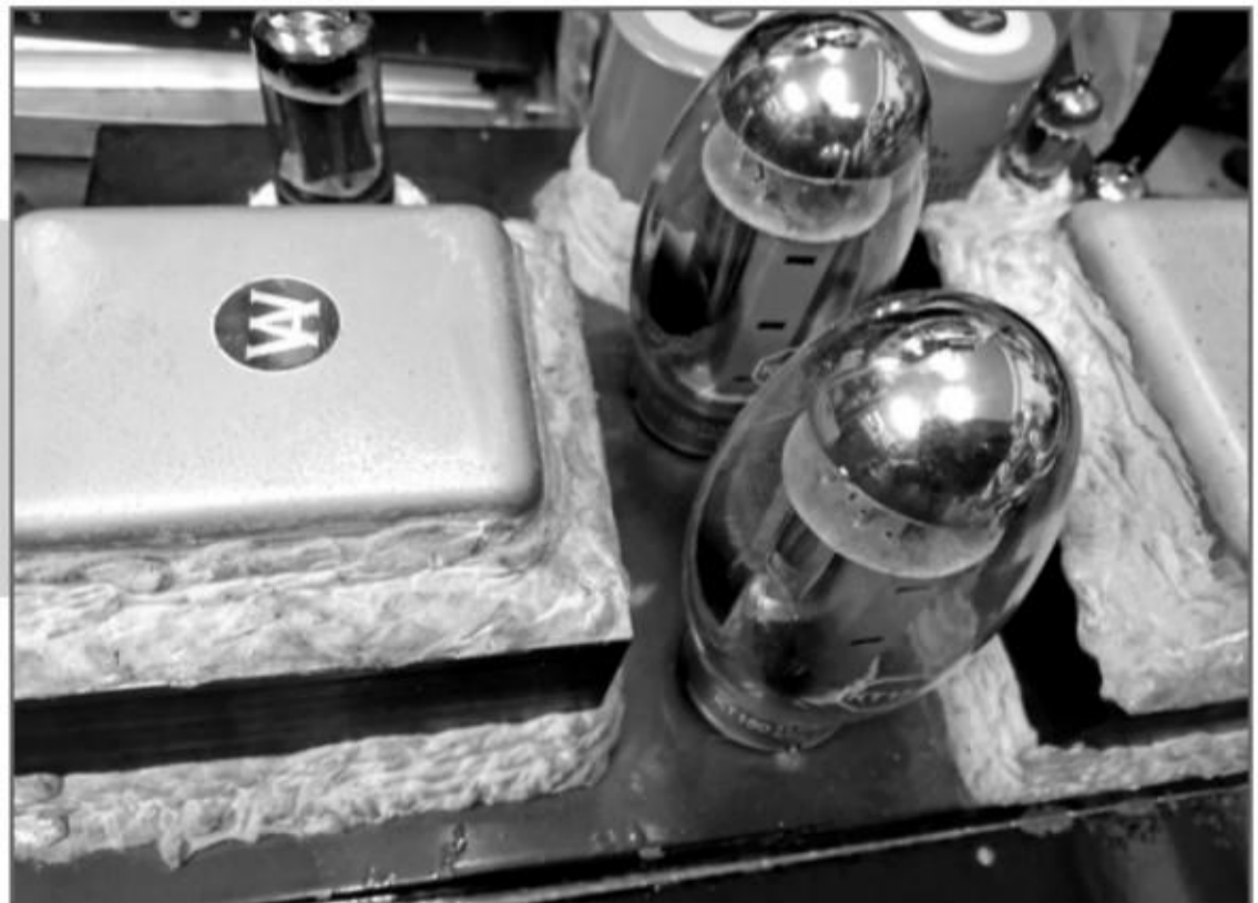
原廠輸出強放管採用 8417，現時市面比較難買得到，試過插上 KT-150，之後開聲聽過音效頗佳。
