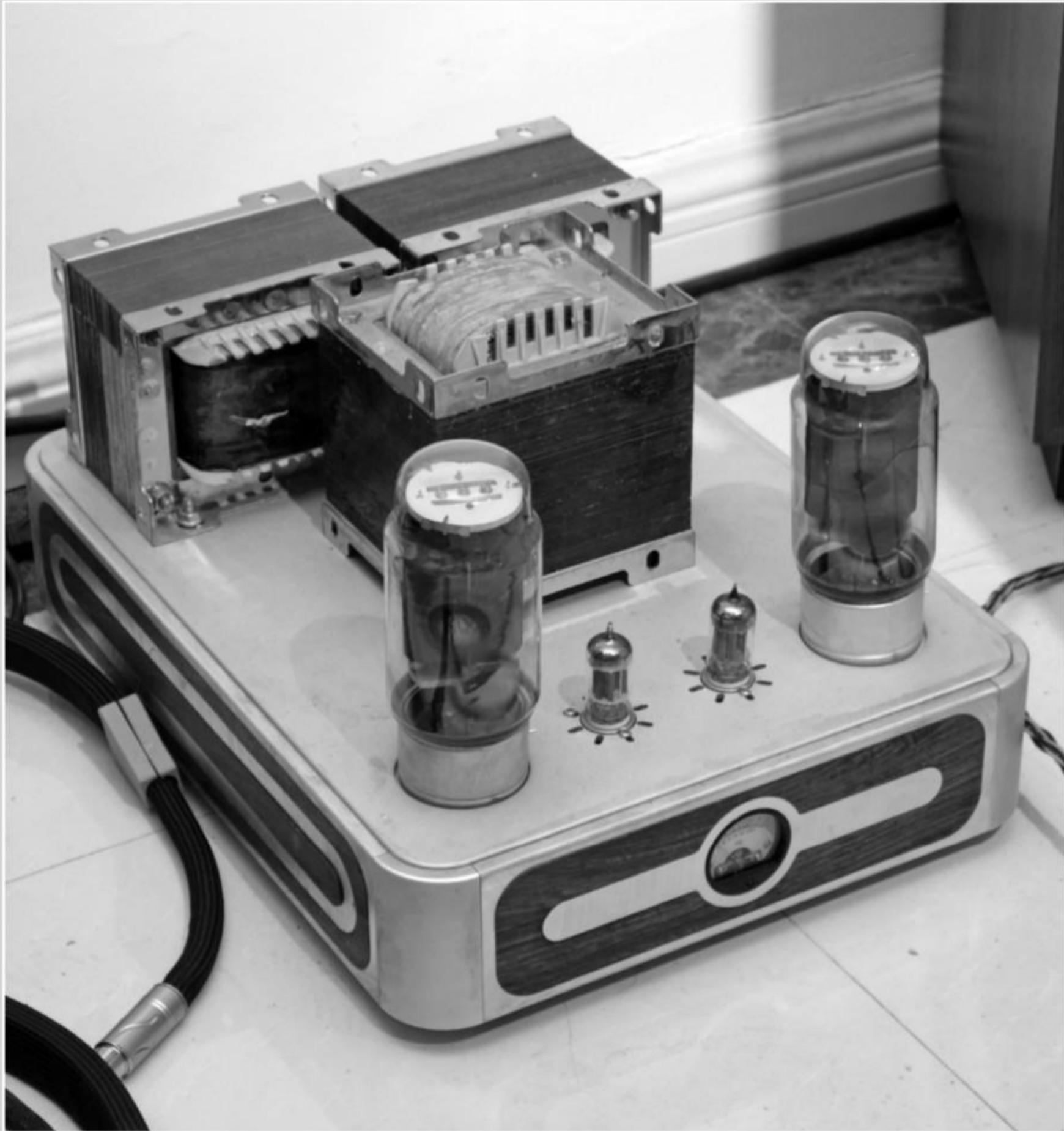
強哥對石機和膽機同樣精通，此乃採用GM70打造的膽後級。
