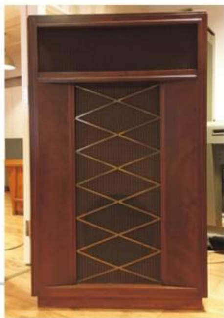
JENSEN Imperial 號角喇叭 三路設計、全恆磁單元，聲音平衡度佳，定位效果出色
