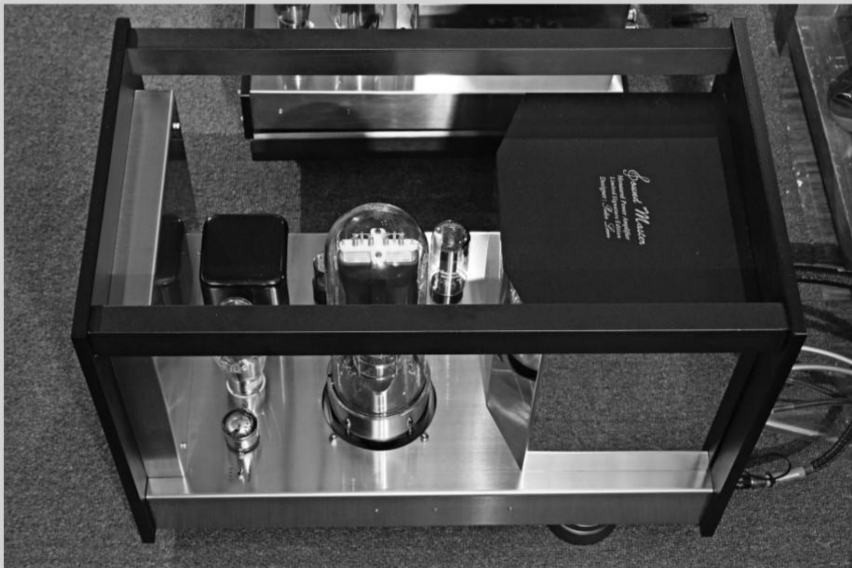
No.212WE 機箱頂部左右兩沿用作連接前後面板的方柱，此支撐柱的概念，某程度是借鏡自賽車所用的 anti-roll bar 防滾架。
