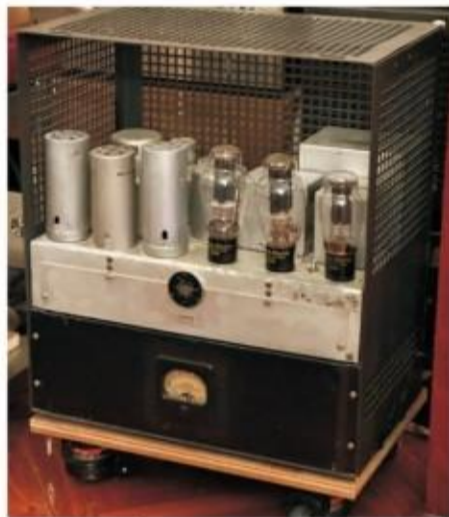
《西電》 86膽機 推挽 300B 的代表作， 聲音雄渾， 音樂味濃， 推動古董、 現代喇叭 同樣出色
