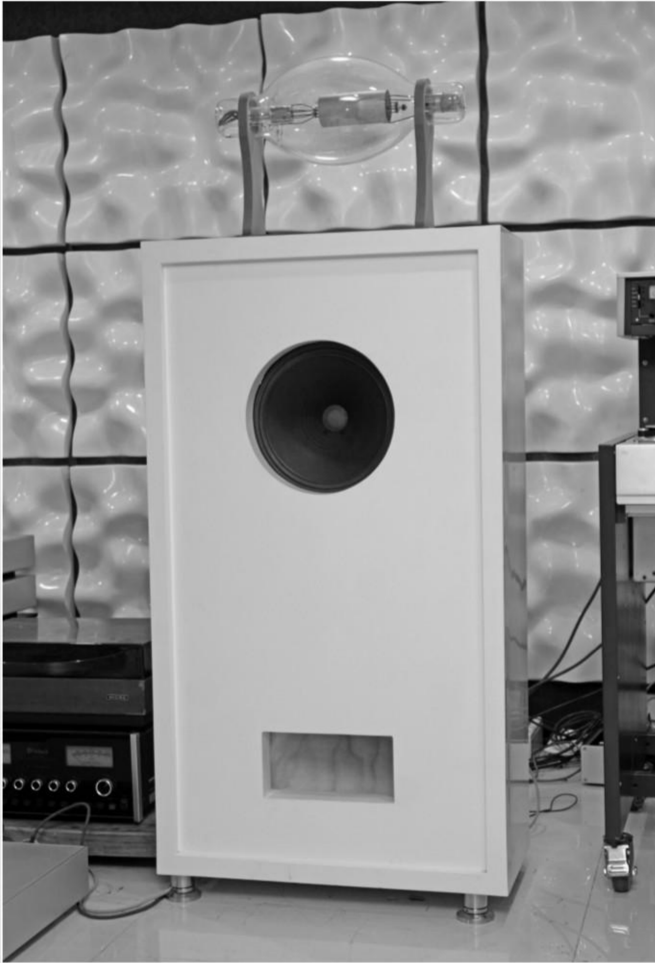
另外一位 DIY 主角，就是這款用特殊材料打造音箱，以 VITAVOX 古董 12 吋全音單元為核心的大型揚聲器。
