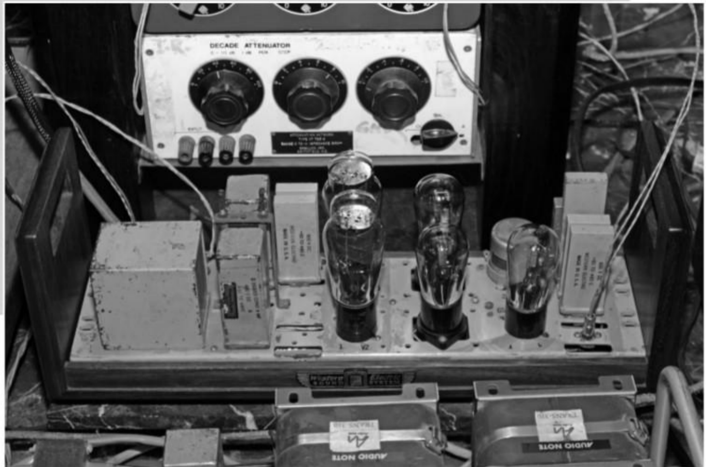
推挽 275A 膽後級以古董《西電》618B 進行倒相工作，可謂不惜功本。
