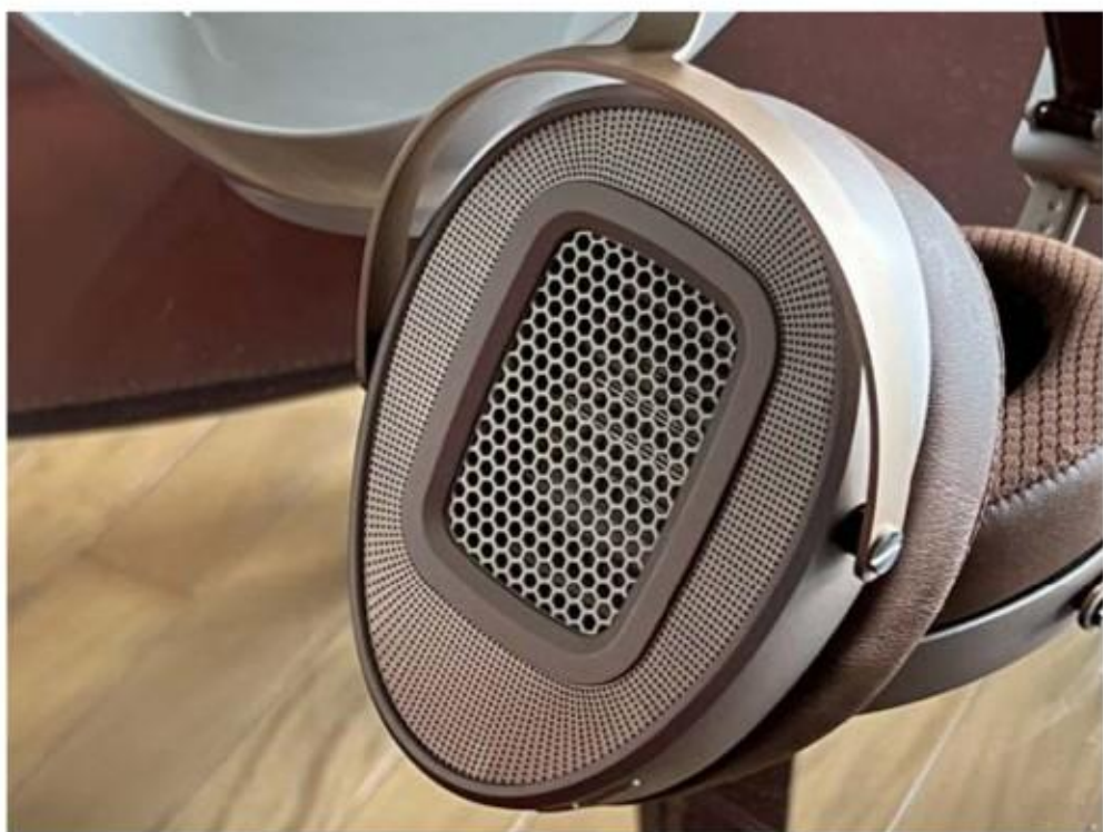
● HE1000 WiFi的耳罩是有保護設計的，但也考慮到讓平面振膜「透氣」的重要性，所以用二種鏤空方式來保證振膜不受回彈氣流影響。
