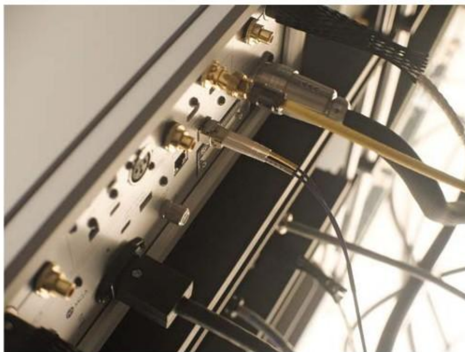
●這是總編上一期才評論過的Esoteric最新旗艦Grandioso N1串流DAC，這次試聽外接了PS1電源供應器與自家時鐘處理器，請注意網路串流使用了Esoteric首度配備的SFP光纖進行傳輸。
