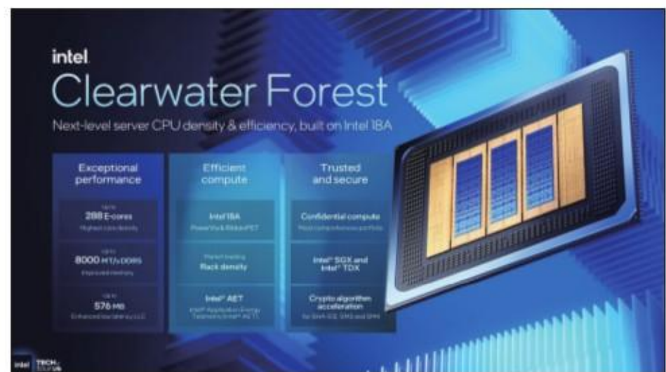
Clearwater Forest規格上的亮點包含最高288組核心、576 MB末端快取記憶體、12通道DDR5-8000記憶體等。
