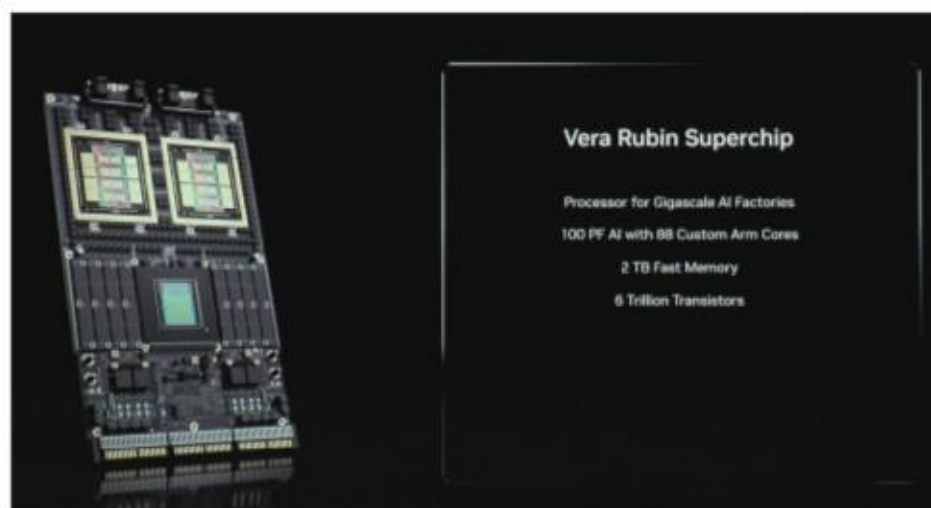
Vera Rubin Superchip由6兆個電晶體構成，能夠提供100 PFLOPS運算效能，並搭載總容量達2 TB的記憶體。
